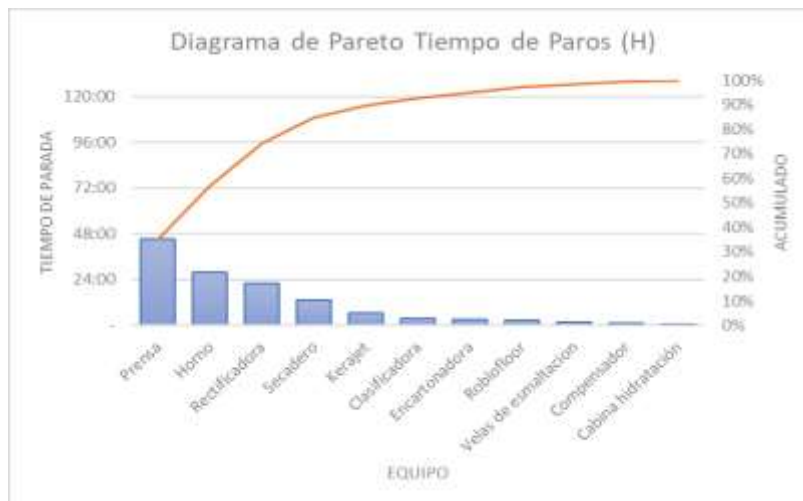
Ilustración 7-3: Análisis de Pareto según el tiempo de paro Realizado por: Andrade, D & Villarreal, A. 2023.
