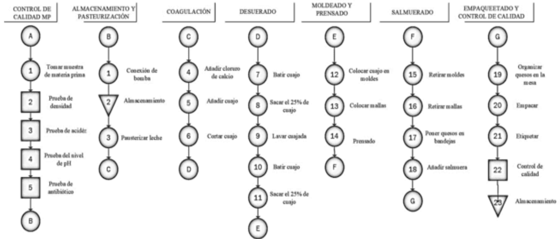
Ilustración 22-4: Diagrama de flujo del proceso propuesto para la empresa El Va'Quero
