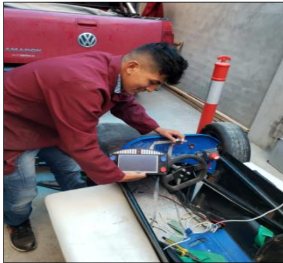
Figura 19-3: Montaje del tablero en el vehículo
