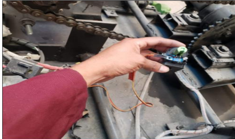
Figura 21-3: Colocación del sensor para medir la velocidad
