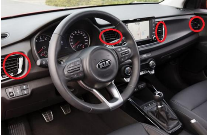
Figura 2-1: Ubicación de las salidas de aire acondicionado en el interior del vehículo Realizado por: Eugenio Lizandro, 2021.
