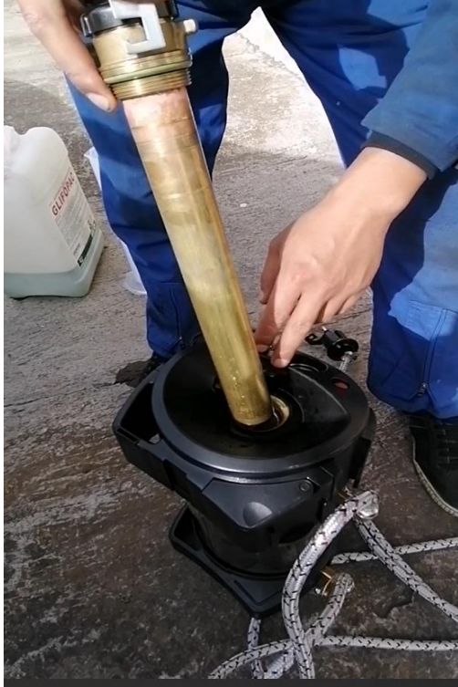
Remoción de tapa roscada del equipo
