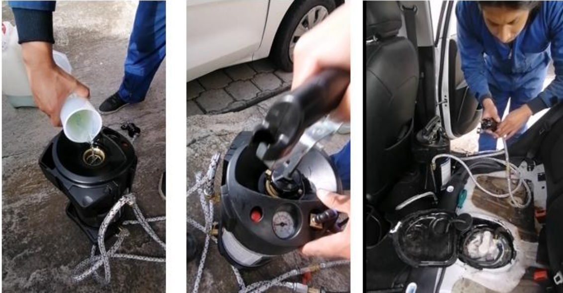
Figura 6-2: A) Llenado del equipo Jet Clean Plus con probeta graduada de 1000 ml B) Presurización del equipo. C) Instalación del equipo en las líneas de alimentación del vehículo.
