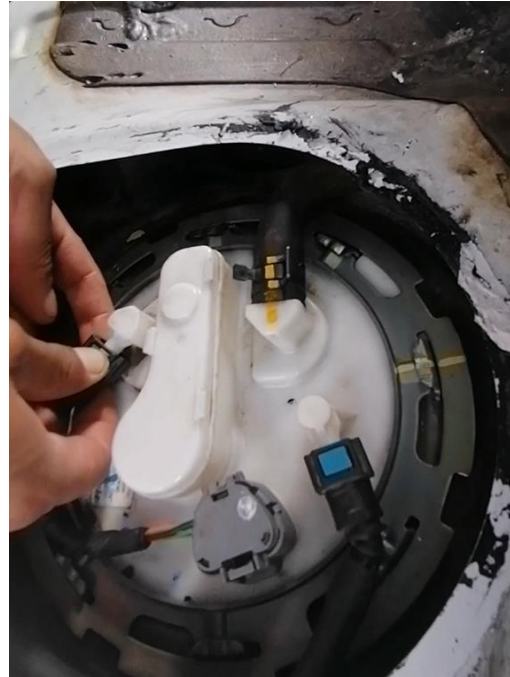
Desmontaje de las líneas de alimentación de combustible (salida y retorno)
