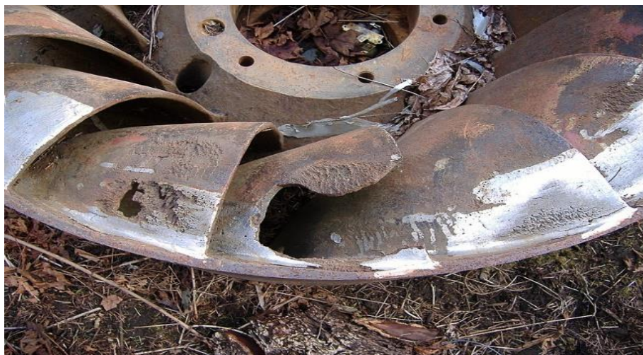
Ilustración 22-2: Turbina Francis, daños por cavitación y reparaciones antiguas con soldadura de acero inoxidable
