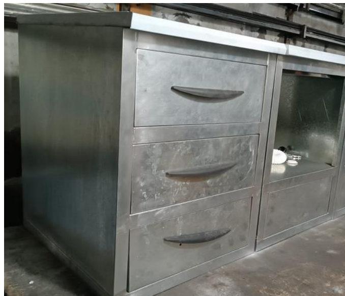
Ilustración 31-3: Ensamble de los cajones en el módulo.
