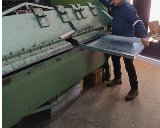
Ilustración 21-3: Plegado del material.
