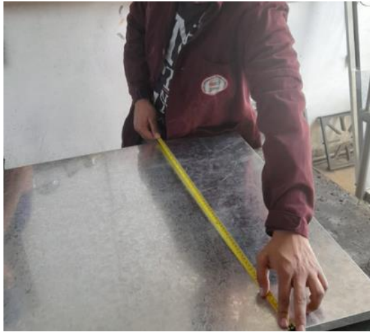
Ilustración 19-3: Medición en la chapa de acero galvanizado.
