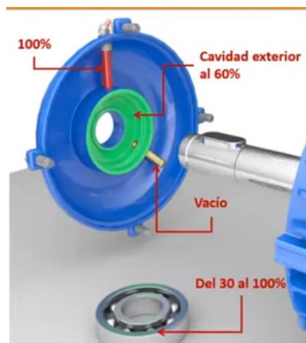
Figura 4-2: Espacio interno del rodamiento.
