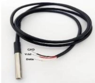
**Ilustración 16-3:** Sensor de temperatura tipo sonda LM35
