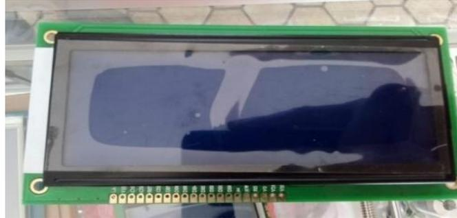
**Ilustración 10-3:** Pantalla LCD de 20 x4 pixeles
