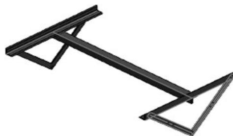
**Ilustración 22-3:** Diseño del sistema de anclaje
