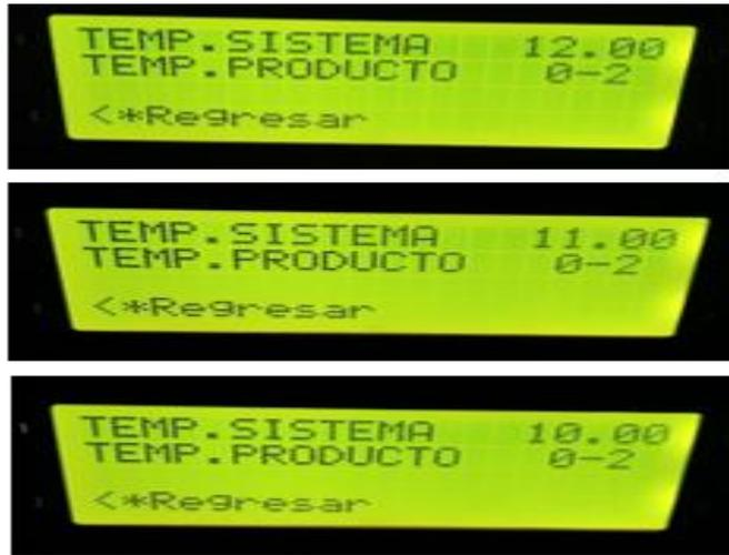
**Ilustración 9-4:** Control de temperatura del sistema de refrigeración
