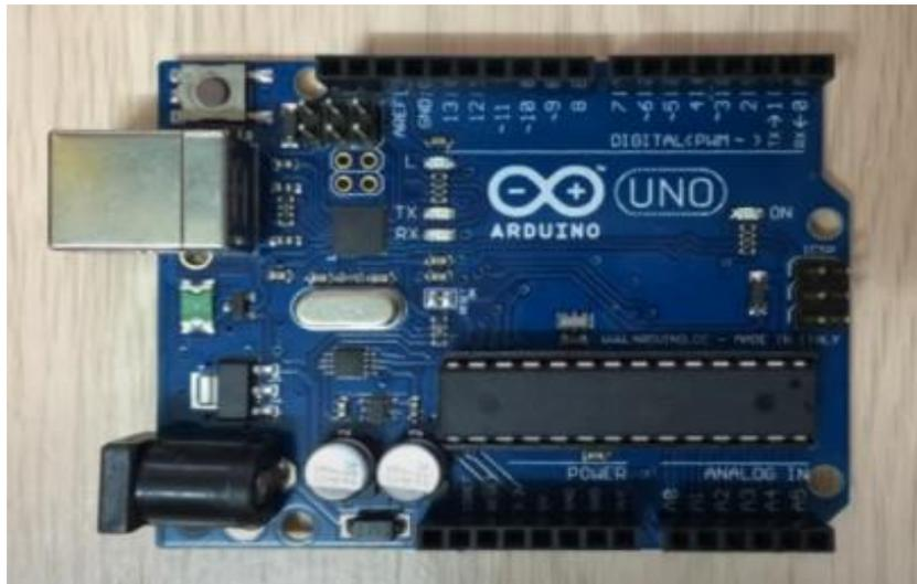
**Ilustración 9-3:** Tarjeta de mando del microcontrolador
