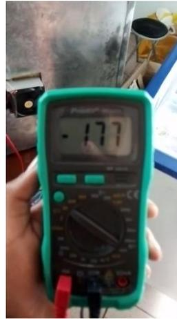
**Ilustración 6-4:** Corriente nominal del sistema sin carga.
