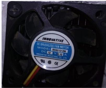
**Ilustración 8-4:** Amperaje de cada ventilador disipador externo según características de placa.
