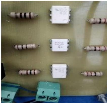
**Ilustración 11-4:** Optoacopladores 4N35 para el circuito de potencia.
