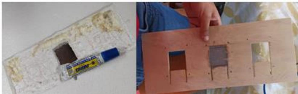
**Ilustración 17-3:** Aislantes térmicos del circuito de potencia
