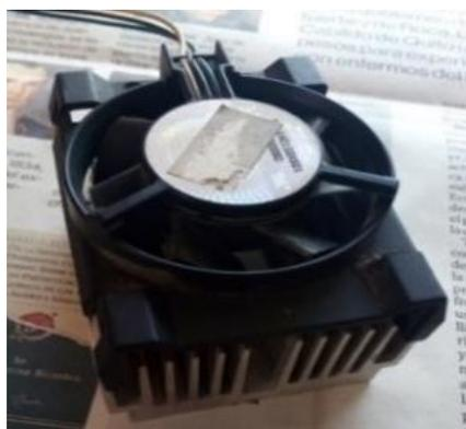
**Ilustración 15-3:** Disipador de temperatura
