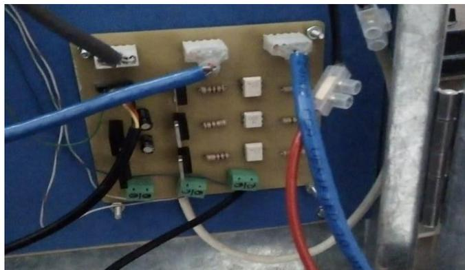
**Ilustración 10-4:** Tarjeta de potencia del sistema de refrigeración
