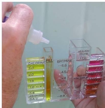
Figura 23. Colorímetro de ortotolidina
