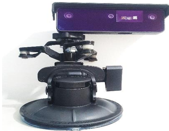
Ilustración 7-3: Conjunto formado por soporte de ventosa, amortiguador y Luxonis OAK-D Pro
