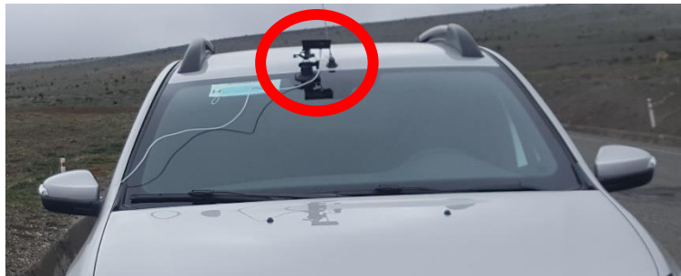
Ilustración 8-3: Ubicación de dispositivo Luxonis OAK-D Pro en Renault Stepway
