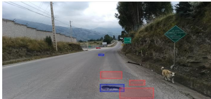
Ilustración 2-4: Etiquetado de imágenes de la base de datos para el sistema de detección de baches
