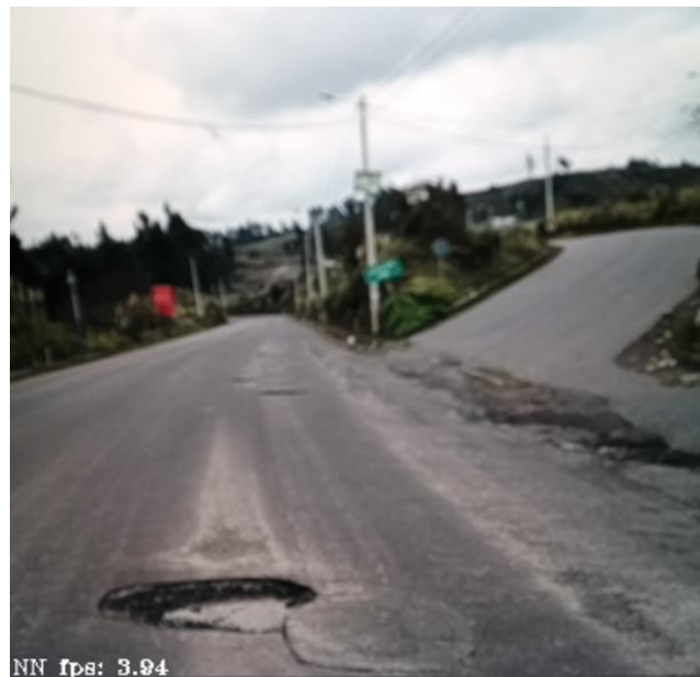
Ilustración 14-4: Ejecución del modelo de detección de baches utilizando VPU Myriad-X
