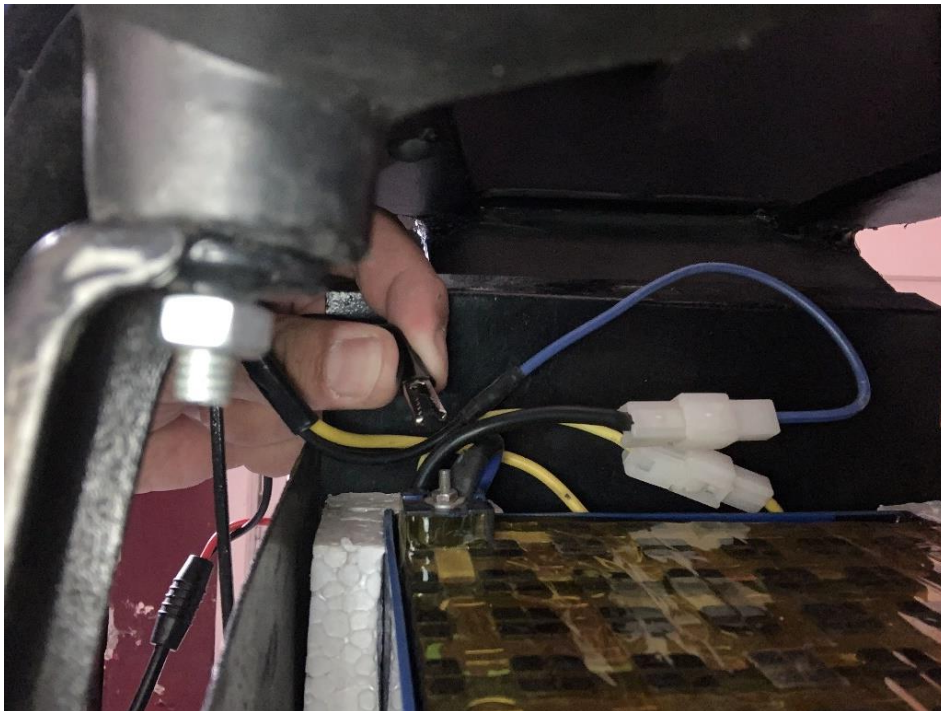
Ilustración 7-3: Conexión del sensor de corriente
