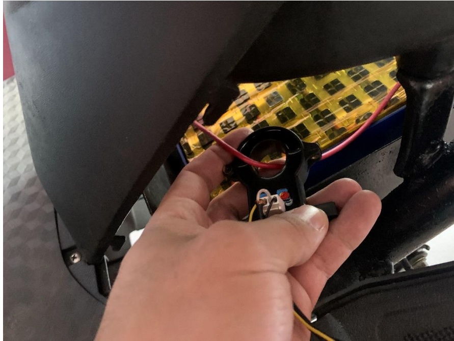
Ilustración 8-3: Conexión al borne negativo de la batería de alta tensión
