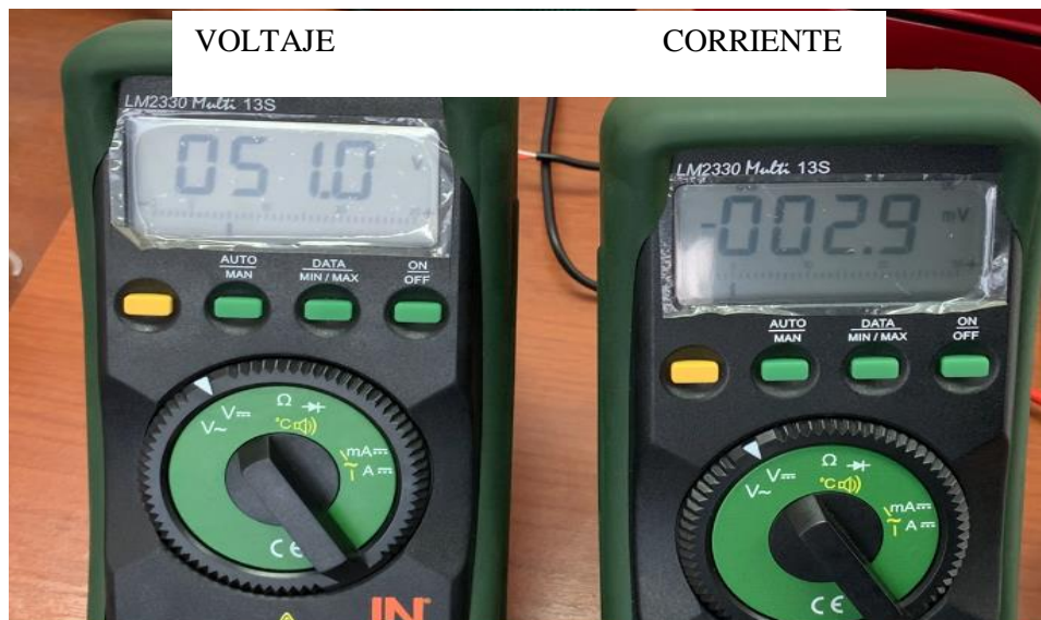
Ilustración 14-4: Valores en multímetroz automotrices antes de la aceleración
