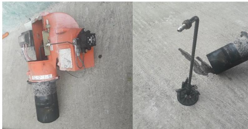
**Figura 10-3:** Quemador del caldero y su boquilla interna
