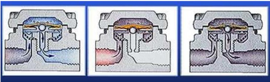
**Figura 7-2:** Trampas termostáticas de presión balanceada
