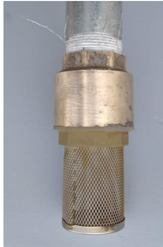
Figura 12-3: Limpieza de la válvula antirretorno.
