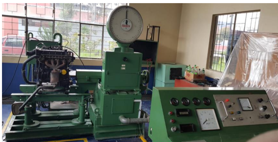
Figura 1-2: Dinamómetro Borghi & Saveri FA 200SP
