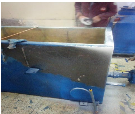
Figura 20-0: Retiró de pintura externa del tanque
