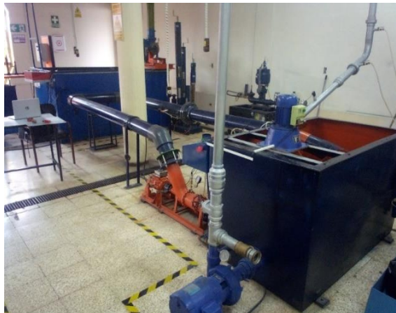
Figura 1-0: Banco de la turbina Turgo y generador
