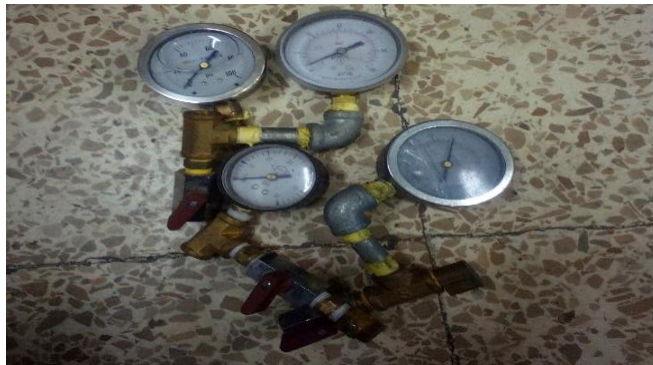
Figura 23-0: Manómetros de presión
