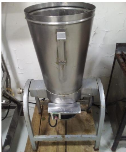
Figura 3-2: Máquina licuadora industrial
