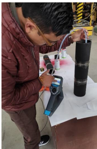
Figura 8-3: Uso del videoscopio en las probetas.
