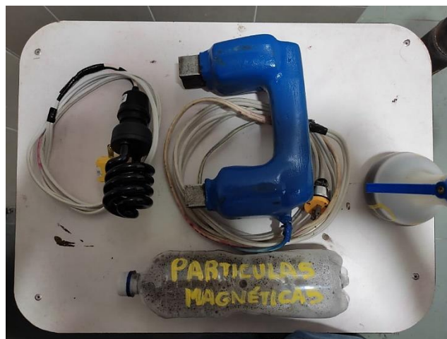
Figura 15-3: Elementos y equipos para la aplicación de MT
