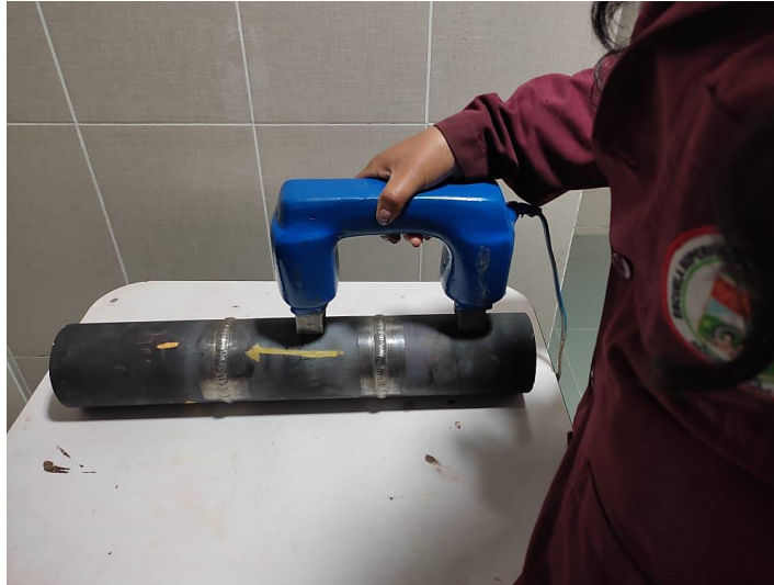
Figura 16-3: Magnetización del área a inspeccionar.
