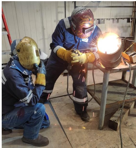
Figura 4-3: Equipos de protección personal para soldadura
