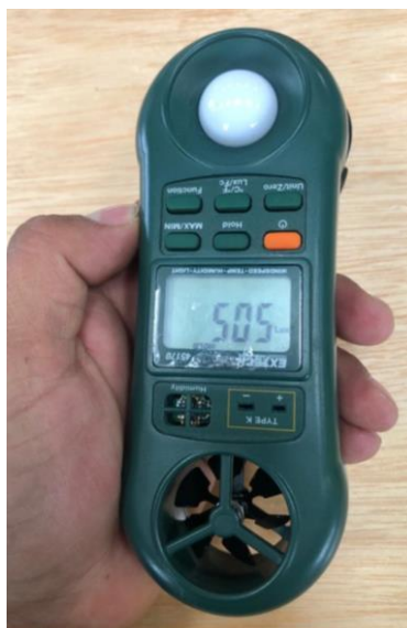
Figura 13-3: Medición de la luminosidad
