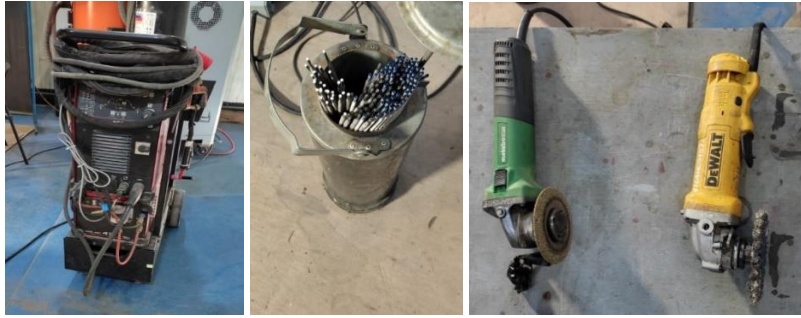
Figura 3-3: Equipo de soldadura, consumibles y herramientas de limpieza
