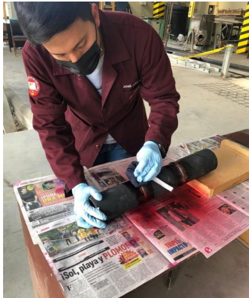
Figura 11-3: Limpieza del exceso de penetrante
