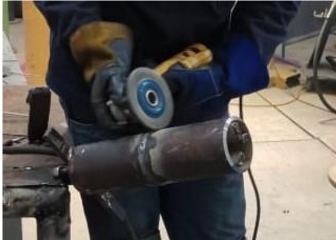
Figura 6-3: Limpieza del cordón de soldadura para aplicación de END
