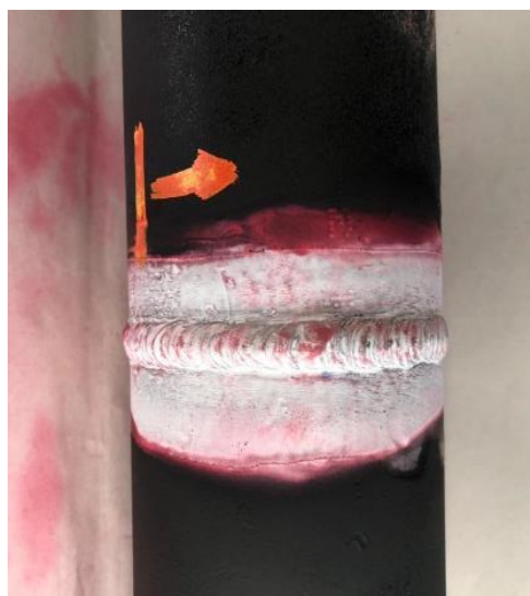
Figura 12-3: Aplicación del revelador en las probetas
