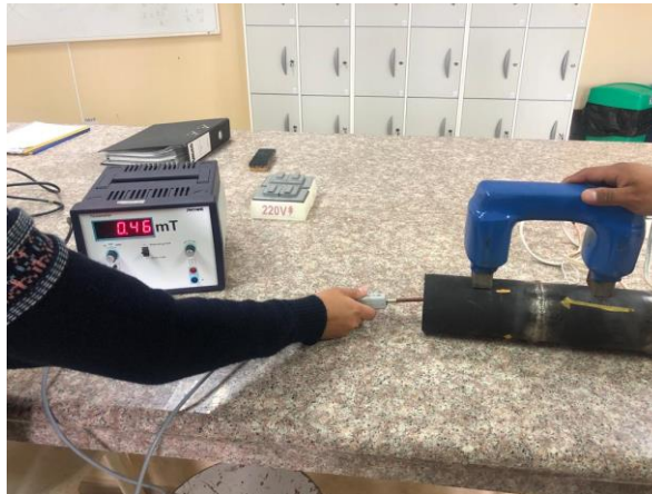
Figura 18-3: Medición del campo magnético mediante un Teslámetro.
