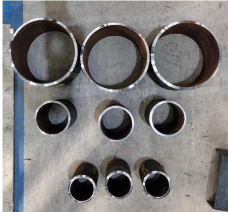
Figura 1-3: Probetas de acero con distinto diámetro y espesor.
