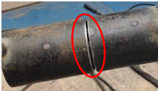
Figura 2-3: Probetas de acero al carbono biseladas con ranura de 60^\circ
