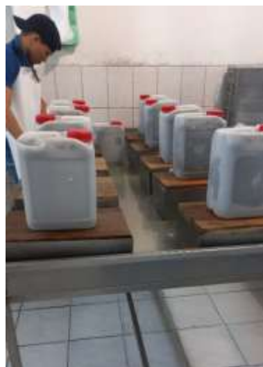
Imagen 11: material no adecuado para el prensado de los quesos (madera)
