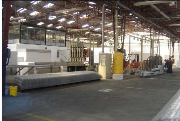
Figura 3.4: Línea de mallado
