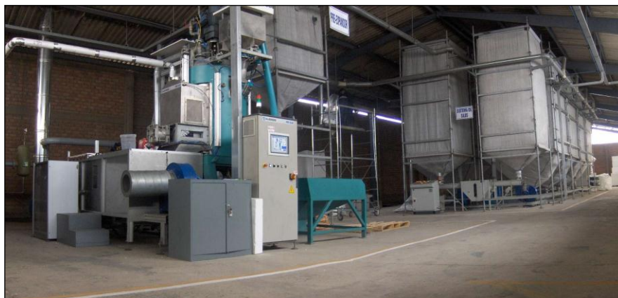
Figura 3.2: Línea de poliestireno expandible
