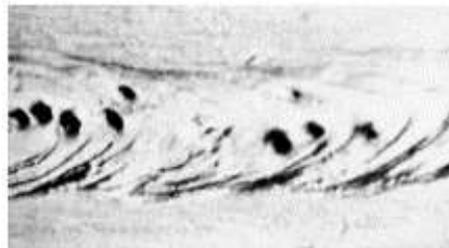
**Ilustración 18-2:** Poros en el cordón de soldadura.
