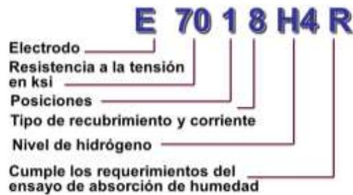
**Ilustración 5-2:** Clasificación AWS A5.1 para electrodos.
