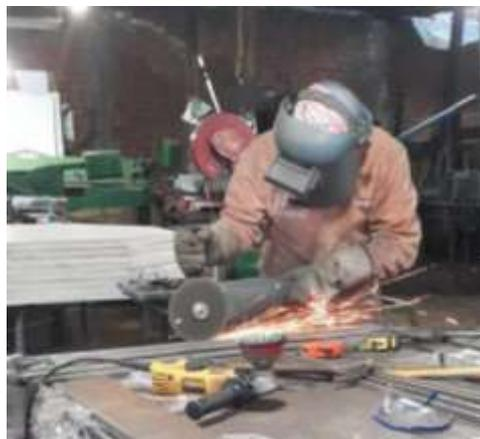
**Ilustración 13-3:** Corte para conformar las probetas.
