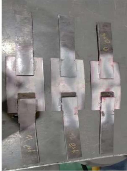
**Ilustración 4-4:** Cupones de 6mm después del ensayo a tracción
