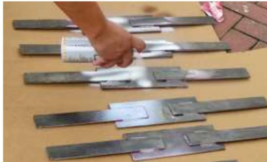
**Ilustración 33-3:** Aplicación pintura de contraste WCP-81.
