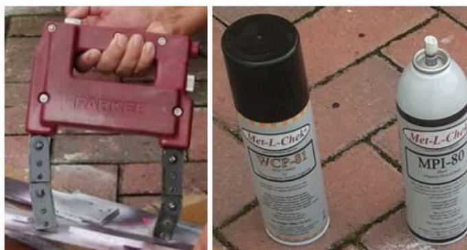
**Ilustración 5-3:** Kit para inspección mediante partículas magnéticas
