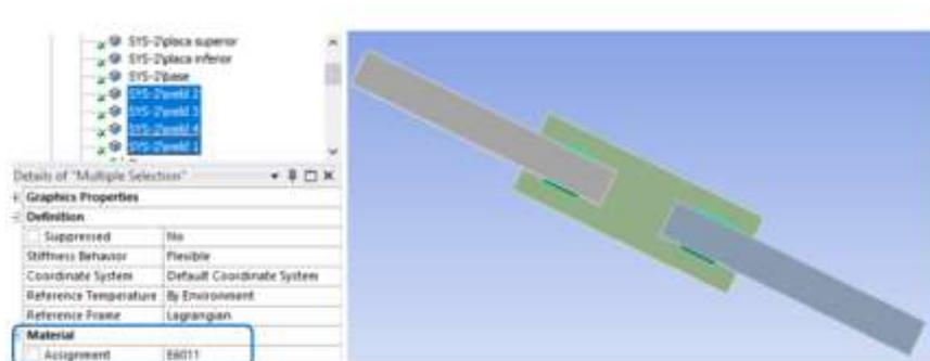
**Ilustración 40-3:** Asignación del material a los cordones de soldadura
