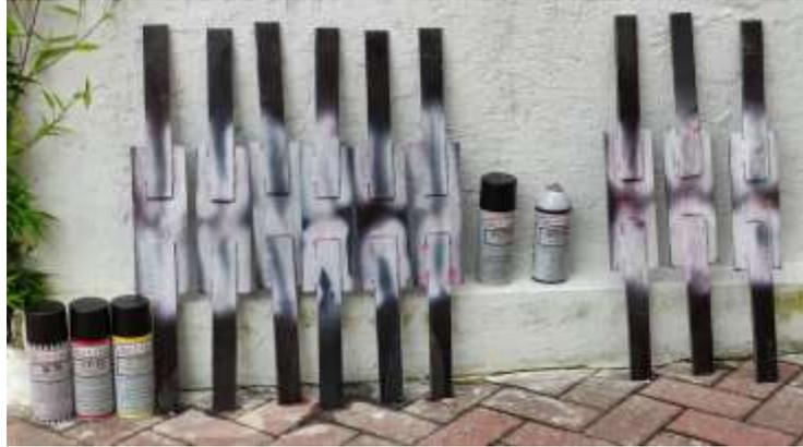
**Ilustración 35-3:** Todos los cupones ensayados mediante NDT.
