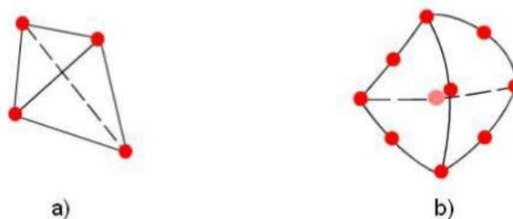
**Ilustración 31-2:** a) Elemento sólido lineal, b) elemento sólido parabólico
