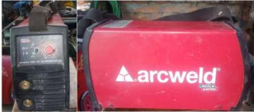
**Ilustración 2-3:** Soldadora inverter arcweld 200i-ST DV
