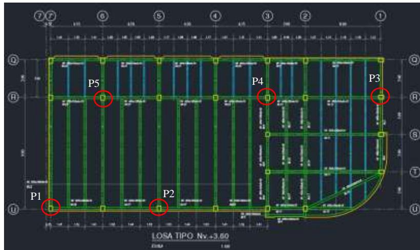
**Ilustración 50-3:** Puntos críticos de las uniones viga columna.
