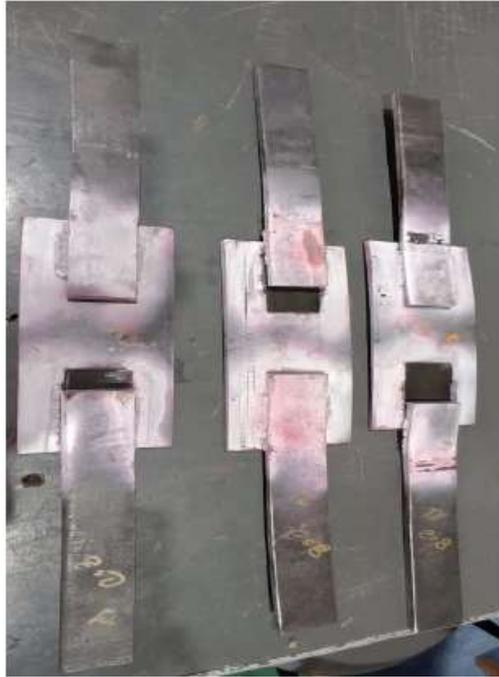
**Ilustración 5-4:** Cupones de 8mm después del ensayo a tracción
