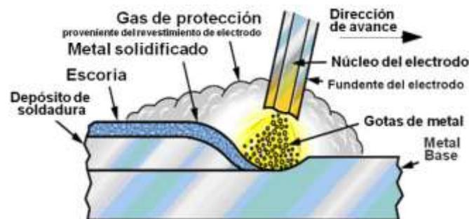
**Ilustración 2-2:** Diagrama esquemático del proceso de soldadura SMAW
