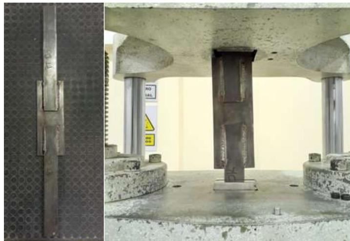
**Ilustración 15-3:** Probeta de prueba ensayada al corte en las soldaduras de filete.
