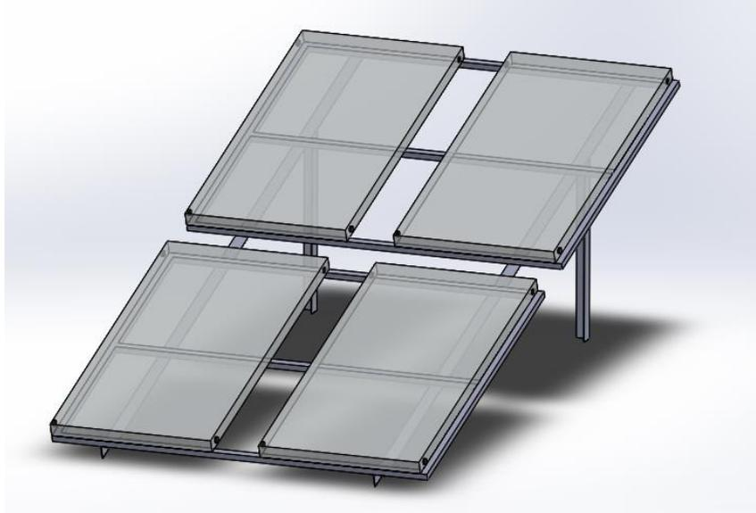
**Ilustración 3-4:** Diseño de la configuración de 4 paneles solares de placa plana.
