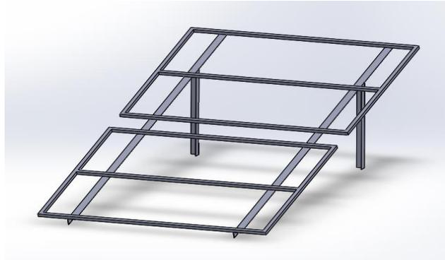
**Ilustración 1-4:** Diseño de estructura para soporte de 4 paneles solares.
