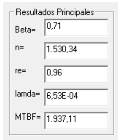
**Figura 4.11:** Parámetros de Fiabilidad en el Sistema de Transmisión
