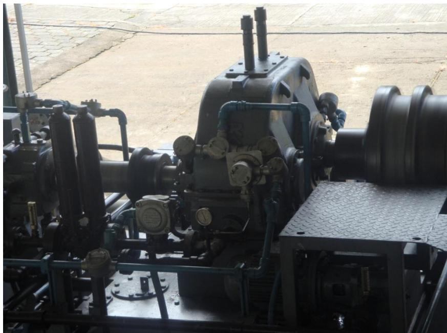
**Figura 3.23:** Carcasa del incrementador
