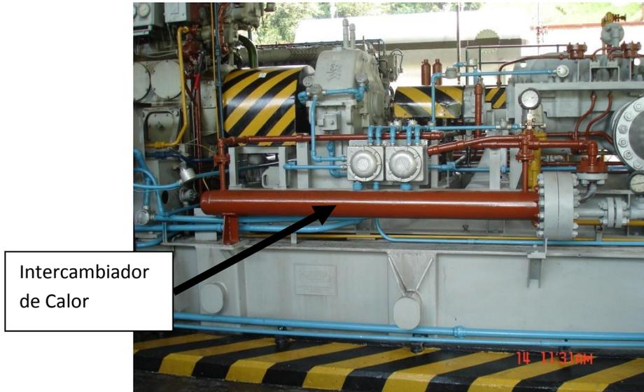
**Figura 3.26:** Sistema de Refrigeración
