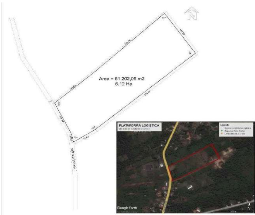
Ilustración 7-5: Georreferenciación y levantamiento planimétrico Realizado por: Buenaño, O & Espín, J. 2022.
