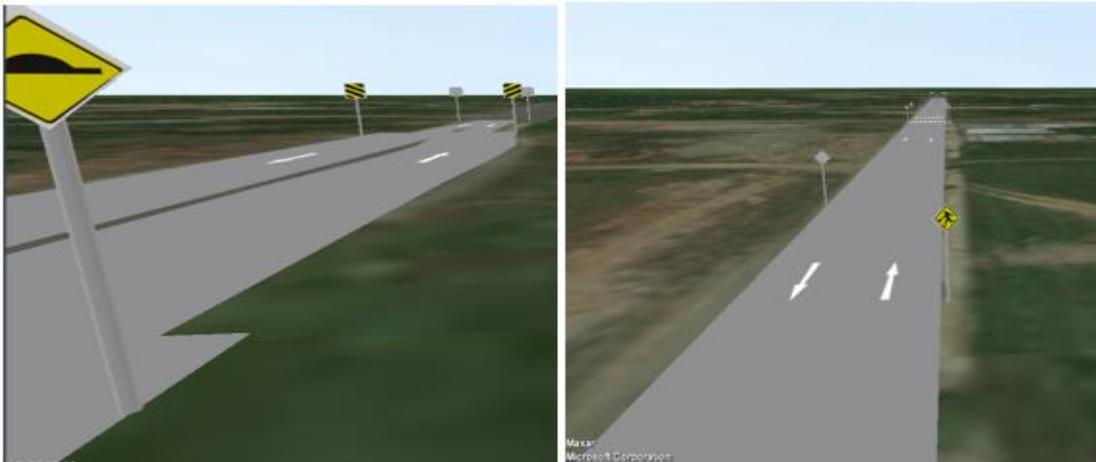
**Ilustración 35-3:** Implementación de señalización vertical en el tramo vial 4
