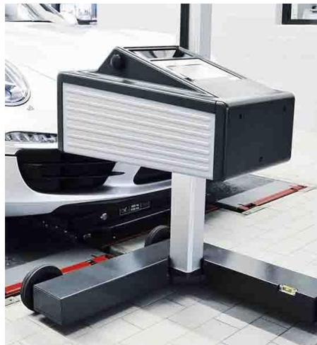
**Figura 16-5:** Luxómetro con regloscopio
