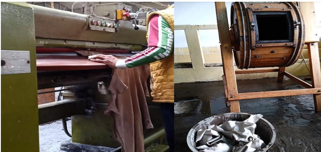
ANEXO M. EVIDENCIA FOTOGRÁFICA DEL PROCESO DE ACABADO EN HÚMEDO DE LAS PIELS OVINAS PARA OBTENCIÓN DE CUERO PARA CALZADO DE DAMA.
