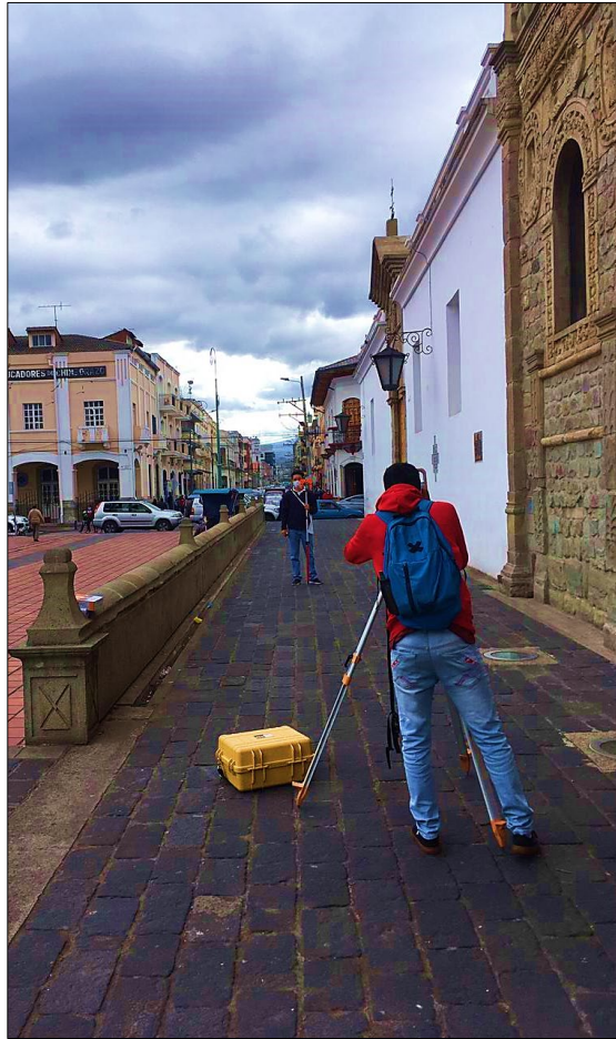
Ilustración 7-F: Calculo de las alturas en la calle Gaspar de Villarroel con el "Nivel" para ver la pendiente.
