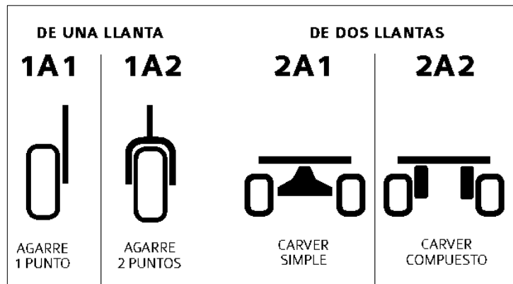
Figura 4-B: Estructura de llantas.
