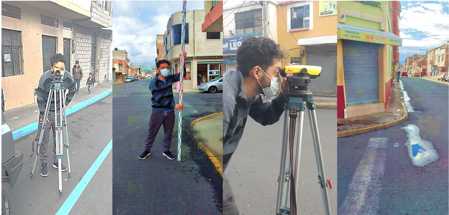
Ilustración 6-F: Calculo de las alturas en la calle Gaspar de Villarroel con el "Nivel" para ver la pendiente.
