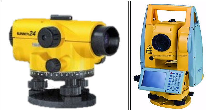
Figura 1-2: Nivel automático óptico y estación total. Fuente: Imágenes Google
