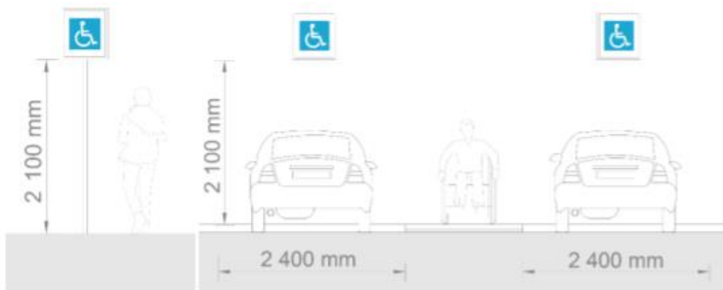
Figura 52-3: Señalización vertical para plazas de estacionamiento para personas con discapacidad y movilidad reducida
