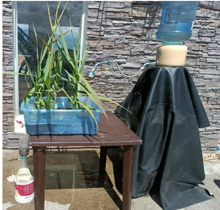
Ilustración 6-3: Humedal artificial de flujo superficial
