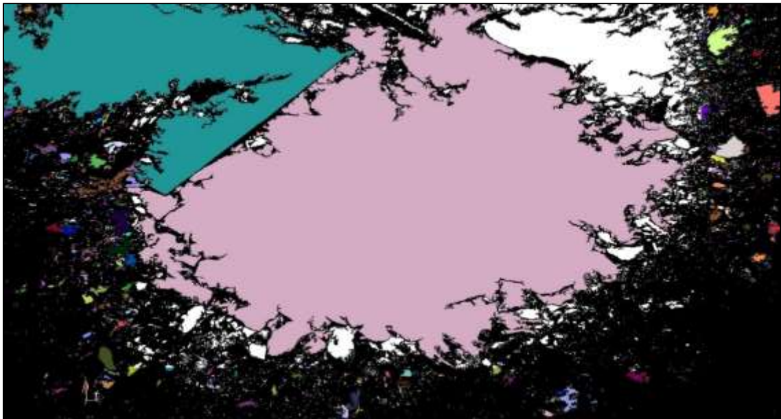
Ilustración 59-4: Contorneo de fragmentos de forma automática en “ImageJ” de la voladura 2 - Fotografía al 100% de material.
