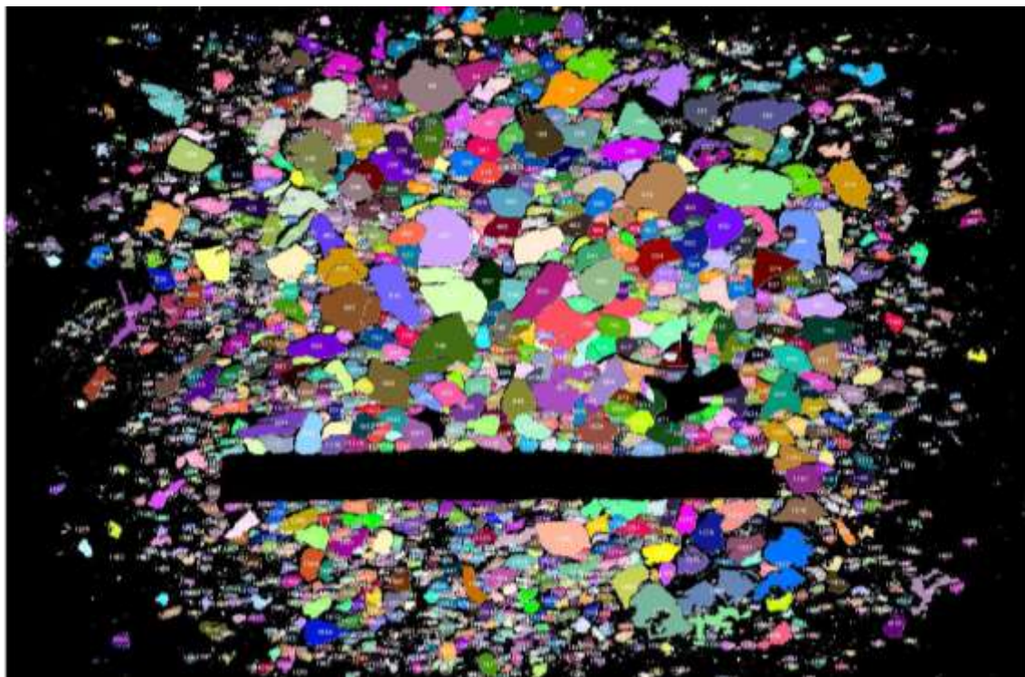
Ilustración 27-4: Análisis de áreas de fragmentos resultantes de la voladura 3 - Fotografía al 75% de material.
