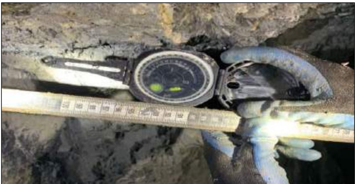
Ilustración 3-3: Toma de inclinación de los barrenos mediante brújula.
