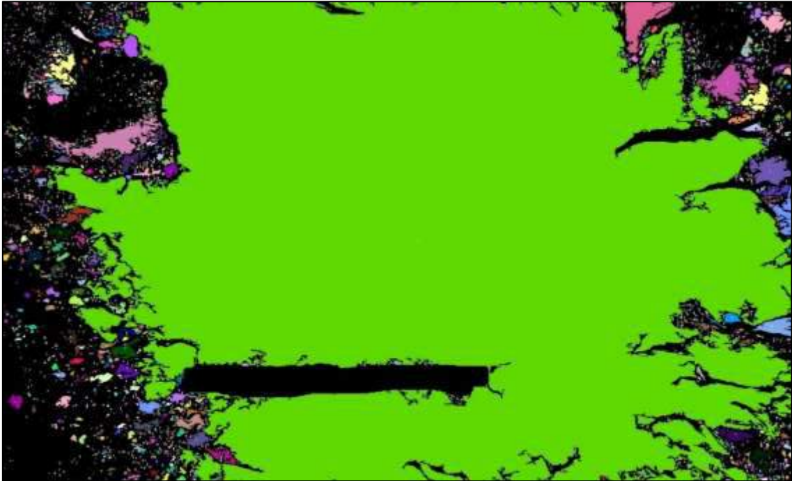
Ilustración 65-4: Contorneo de fragmentos de forma automática en “ImageJ” de la voladura 5 - Fotografía al 100% de material.
