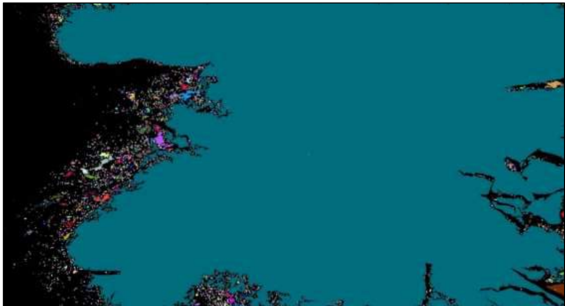
Ilustración 71-4: Contorneo de fragmentos de forma automática en “ImageJ” de la voladura 8 - Fotografía al 100% de material.
