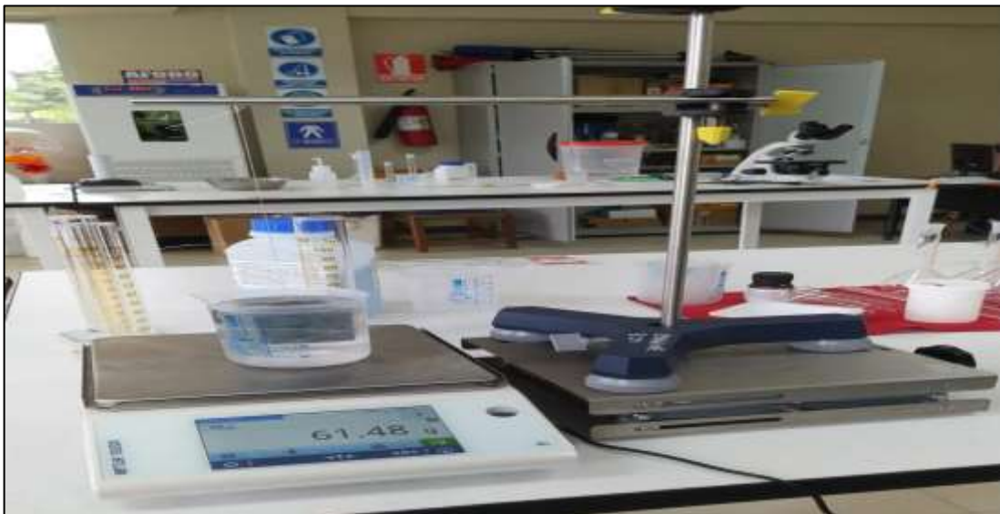
Ilustración 12-3: Ensayo de densidad aparente mediante método de Arquímedes.
