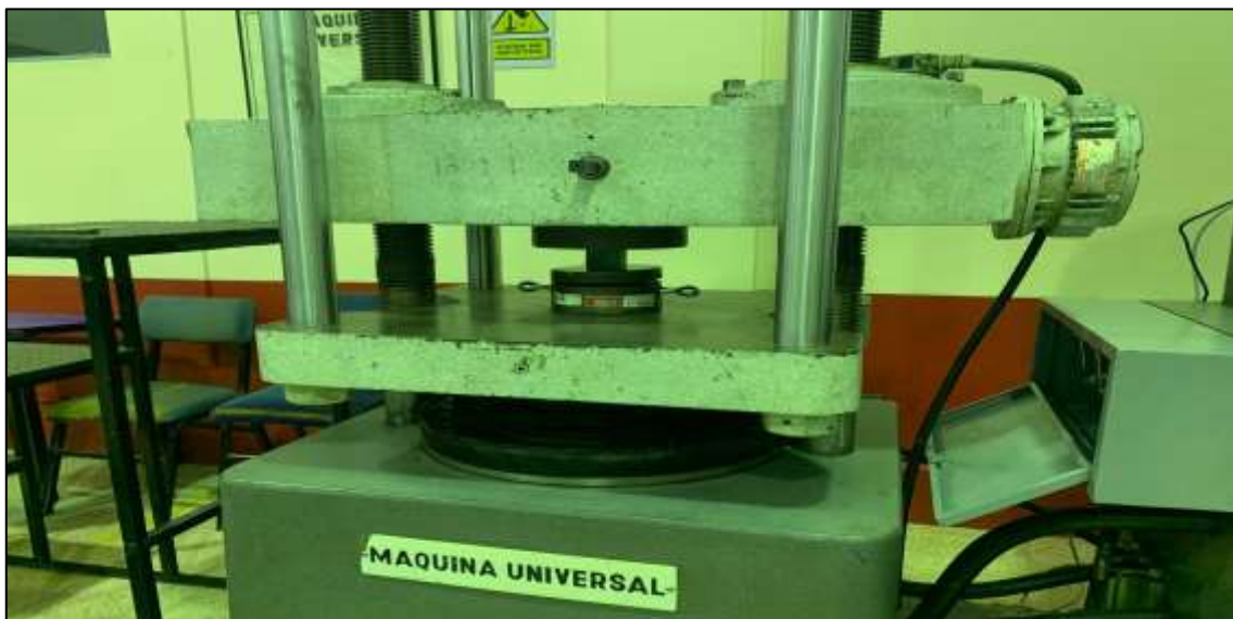
Ilustración 11-3: Ensayo de Compresión uniaxial mediante máquina universal.
