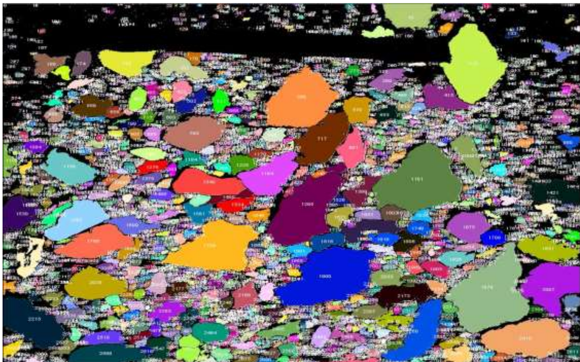
Ilustración 55-4: Análisis de áreas de fragmentos resultantes de la voladura 10- Fotografía al 100% de material.
