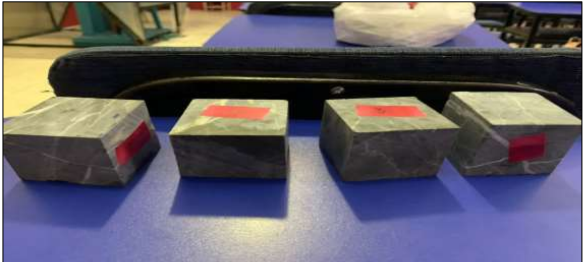
Ilustración 16-3: Probetas de roca para análisis de resistencia a la compresión uniaxial.
