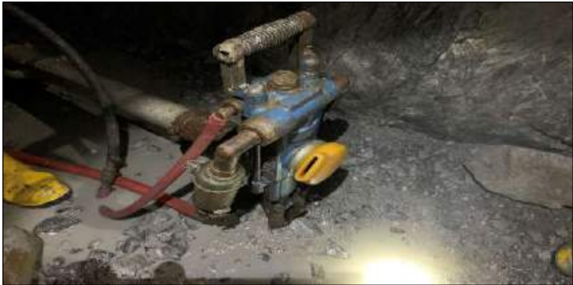
Ilustración 2-3: Máquina de barrenación modelo YT27 con barrenos de 1.20 m
