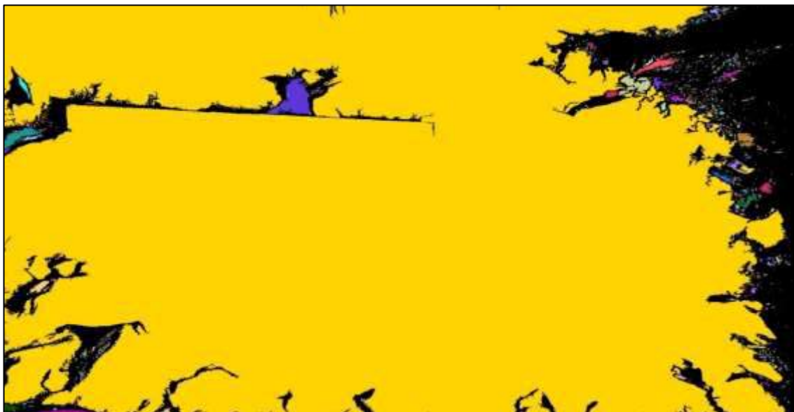
Ilustración 63-4: Contorneo de fragmentos de forma automática en “ImageJ” de la voladura 4 - Fotografía al 100% de material.
