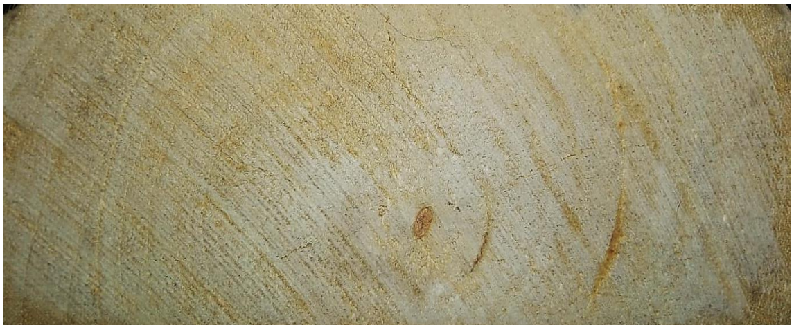
Ilustración 9-4. Corte transversal en la madera de Tecoma stans (L.) Juss. ex Kunth (Cholán)
