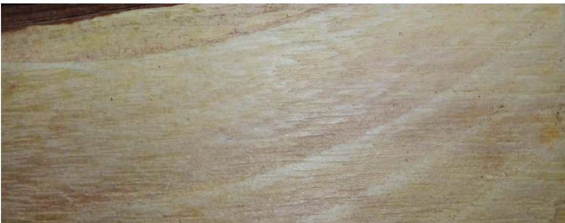
Ilustración 12-4. Corte tangencial en la madera de Caesalpinia spinosa (Mol.) O. Kuntz (Guarango)
