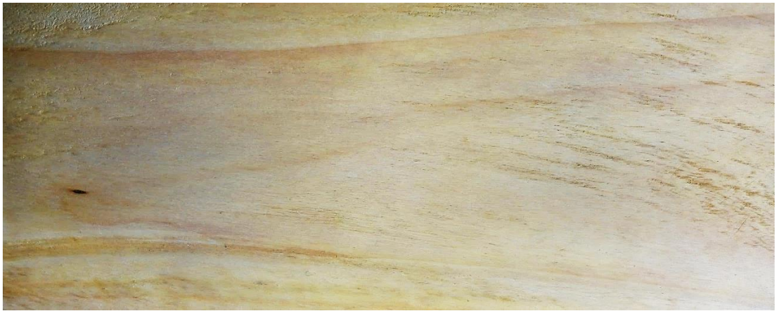
Ilustración 3-4. Corte radial en la madera de Alnus acuminata Kunth (Aliso)
