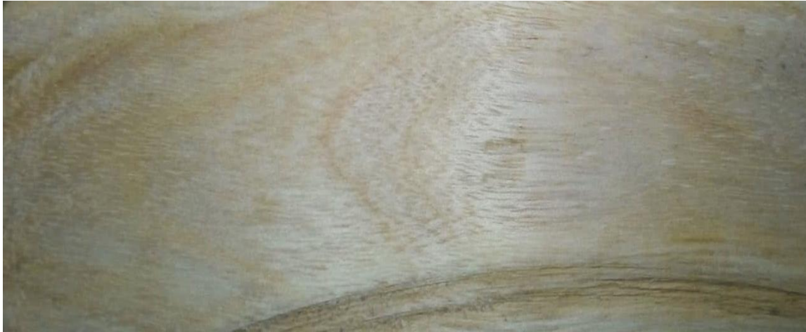
Ilustración 8-4. Corte tangencial en la madera de Tecoma stans (L.) Juss. ex Kunth (Cholán)
