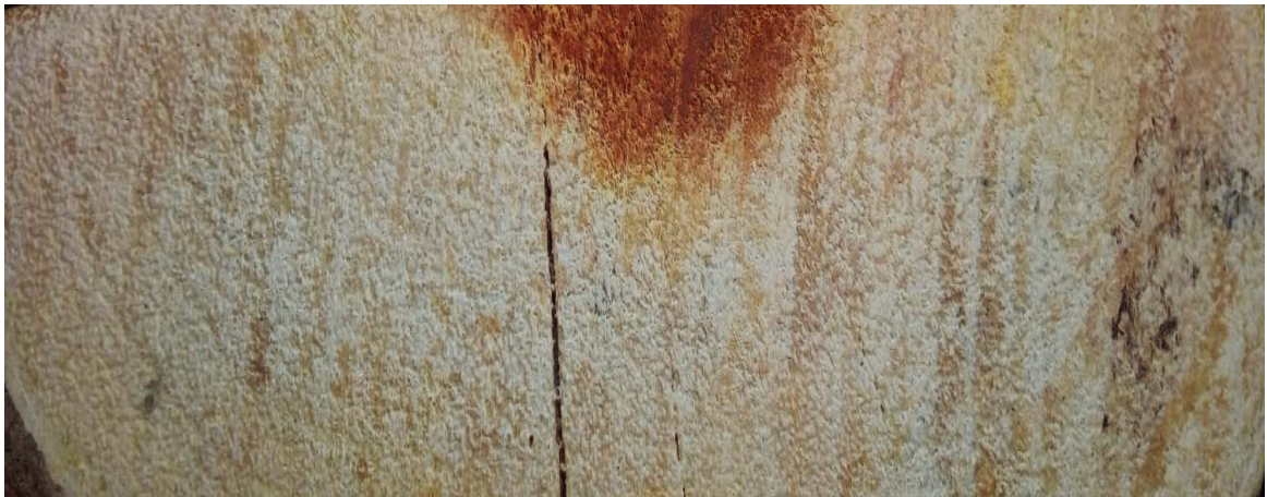
Ilustración 13-4. Corte transversal en la madera de Caesalpinia spinosa (Mol.) O. Kuntz (Guarango)
