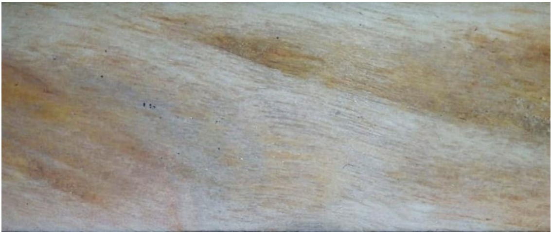
Ilustración 4-4. Corte tangencial en la madera de Alnus acuminata Kunth (Aliso)
