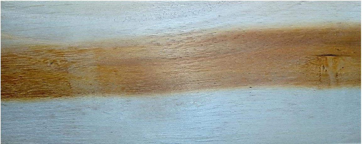
Ilustración 11-4. Corte radial en la madera de Caesalpinia spinosa (Mol.) O. Kuntz (Guarango)
