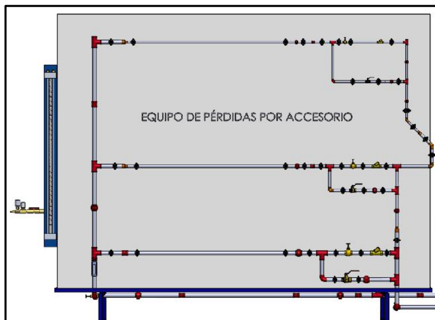
Ilustración 57-3: Tablero de accesorios
