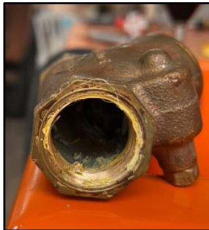
Ilustración 48-3: Válvula check con sarro
