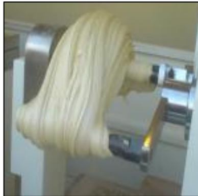
Ilustración 18-2: Amasadora de brazos verticales
