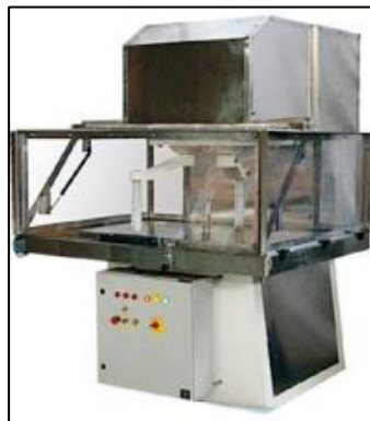
Ilustración 17-2: Amasadora de brazos horizontales
