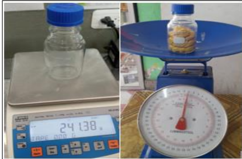
Ilustración 14-3: Pesaje del recipiente de medida vacío y con la melcocha.
