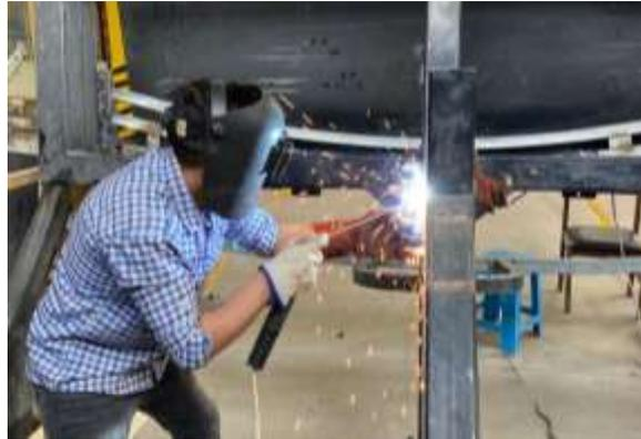
**Ilustración 31-3:** Soldadura de placa de sujeción
