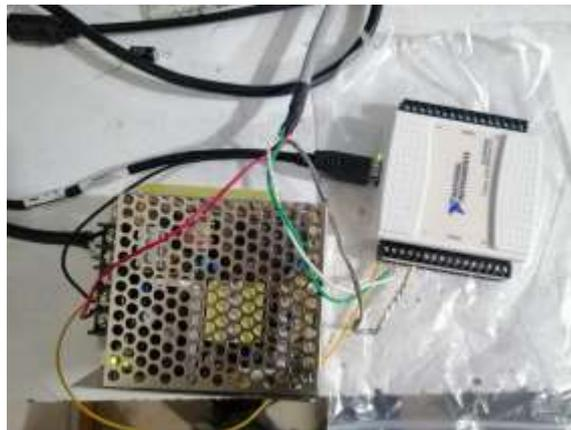
**Ilustración 24-3:** Módulo DAQ y fuente para pruebas.
