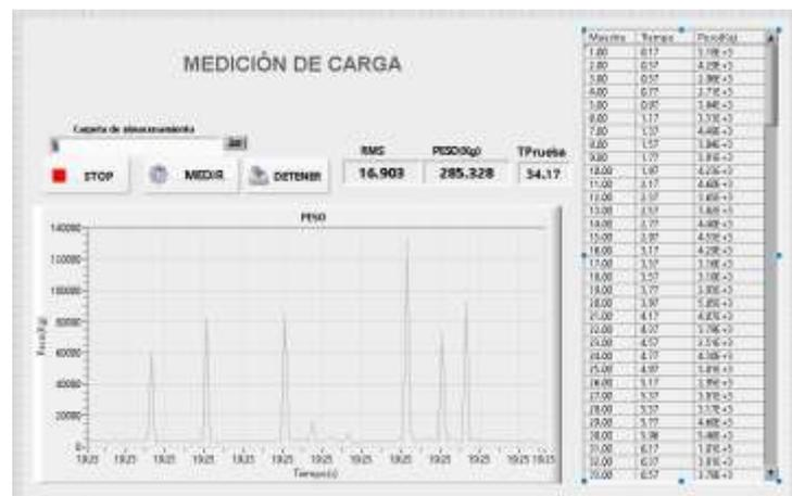
**Ilustración 25-3:** Interface en LabVIEW durante pruebas.
