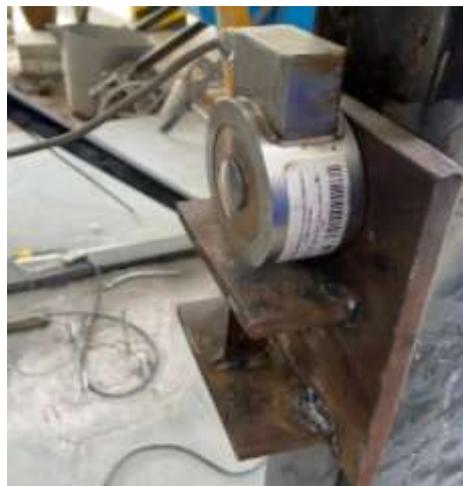
**Ilustración 33-3:** Celda de carga instalada
