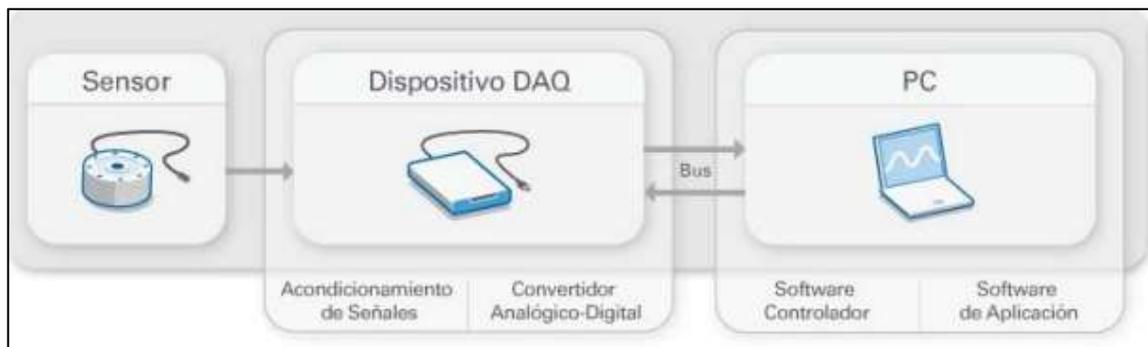
**Ilustración 4-2:** Partes de un sistema DAQ.
