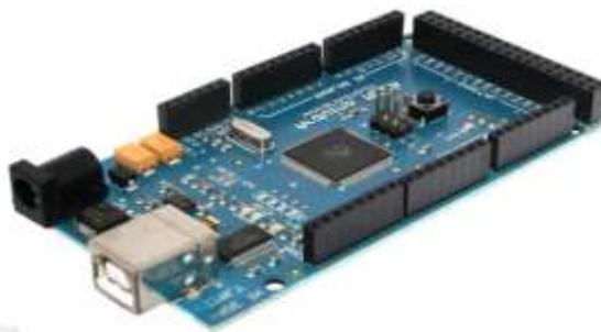
**Ilustración 19-2:** Arduino Mega
