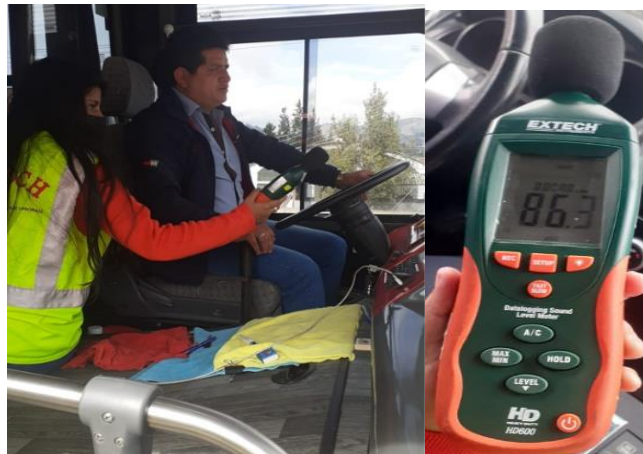
Ilustración 31-3: Toma de datos con el sonómetro modelo HD600 Realizado por: Robayo, Cinthya. 2022
