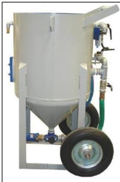
Ilustración 11-3: Tolva de Sandblasting
