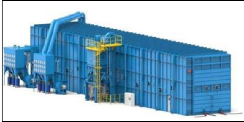
Ilustración 2-1: Cabina industrial de granallado
