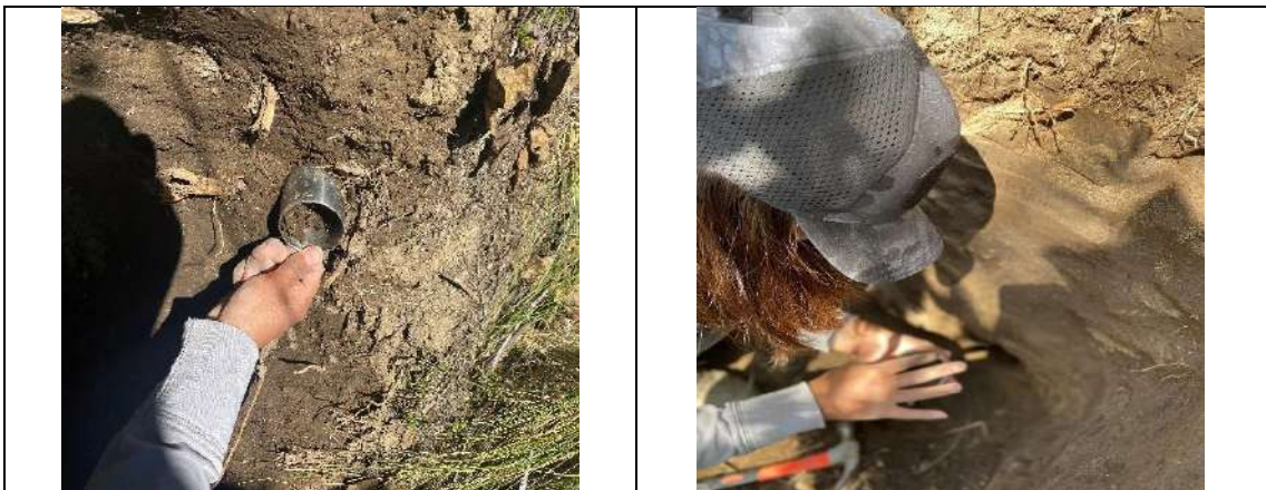
1. Introducción de cilindro para la toma de muestra a profundidad de 0-30 cm.
