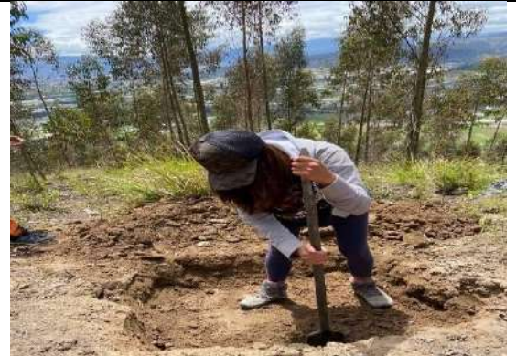
6. Excavaciones de calicata 6
