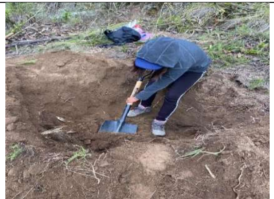
2. Excavaciones de calicata 2
