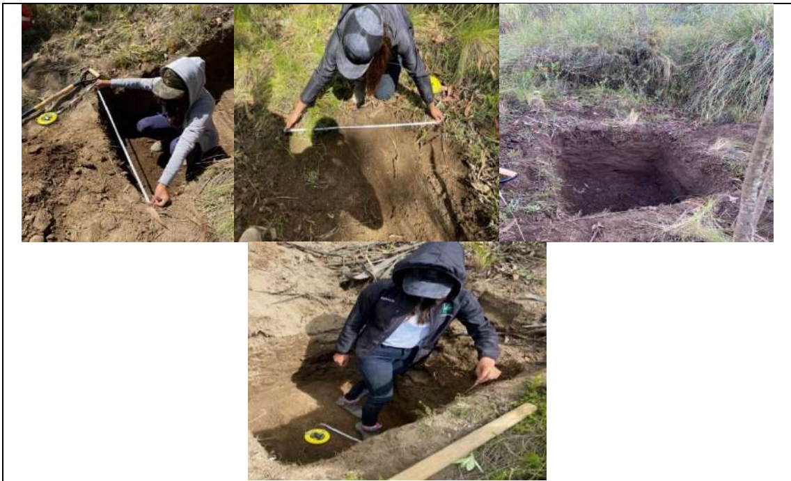
1. Realización de medición de calicatas a dos profundidades
