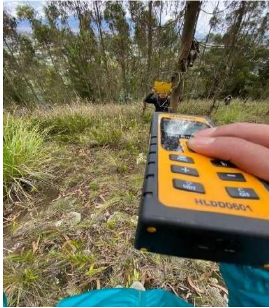
Ilustración 5-3: Registro de copas con el distanciómetro láser
