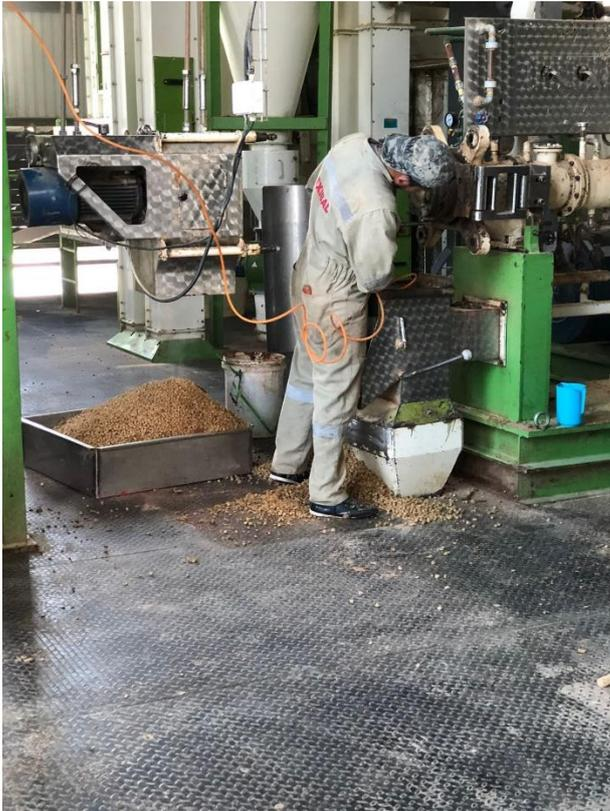
**ANEXO B:** Trituración de balanceado seco para medición
