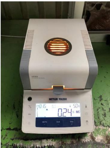
**Ilustración 2-3:** Termobalanza Mettler Toledo HE53/03
