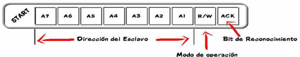
Figura III.7. Direccionamiento del dispositivo I2C de 7 bits
