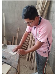
Aplicación de la cera en la probeta
