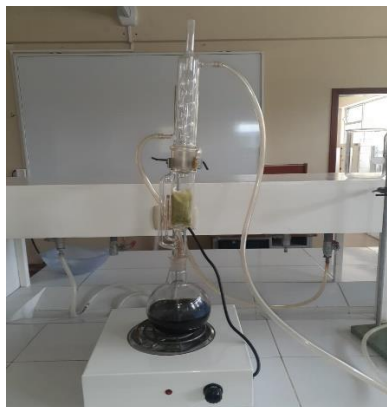
Descarga de la cámara del equipo Soxhlet
