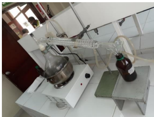
Extracion del solvente con el equipo de destilación
