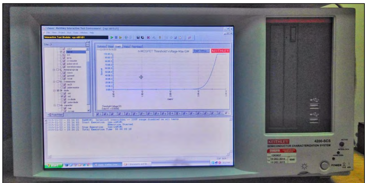
Figura 3-2: Analizador de parámetros keithley 4200 SCS.
