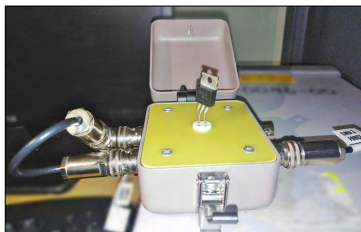
Figura 5-2: Caja metálica y DUT.
