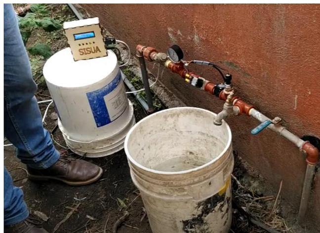
**Figura 5-4:** Primera prueba con presión 93 PSI
