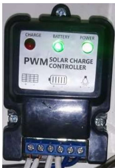
Figura 16-2. Controlador de carga solar Realizado por: Darquea, José; 2020
