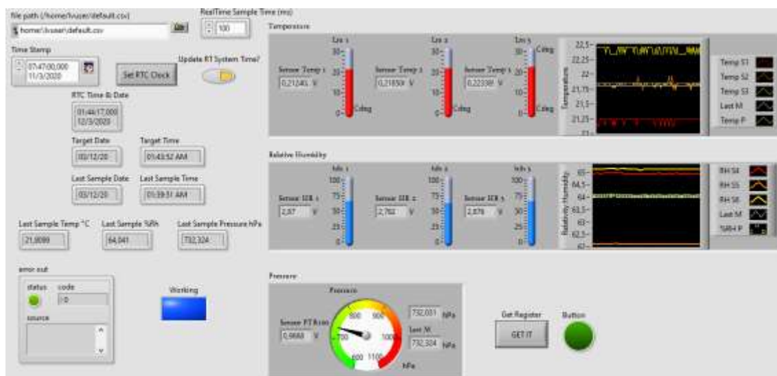
Figura 1-3. Panel frontal del programa de supervisión de la estación meteorológica autónoma.
