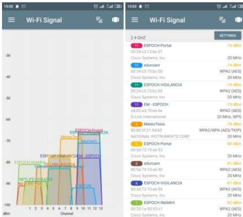
Figura 7-3. Potencia para cada señal Wi-Fi a una distancia de 25m.
