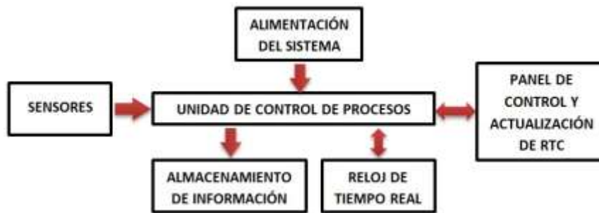
Gráfico 2-2. Diagrama de bloques del módulo principal
