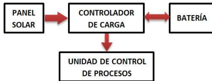
Gráfico 4-2. Diagrama de bloques del módulo de alimentación eléctrica.
