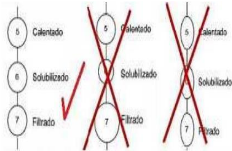
Figura 3 - 2: Comparación entre el tamaño homogéneo y no homogéneo de las operaciones en la elaboración de un diagrama DOP
