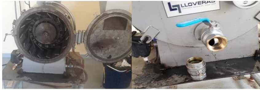
Figura 2-3: Desmontaje de las cuchillas y cambio de válvula
