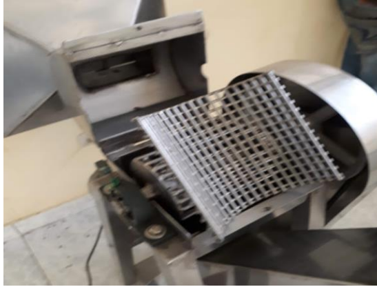
Figura 5-3: Desmontaje del descascarillador
