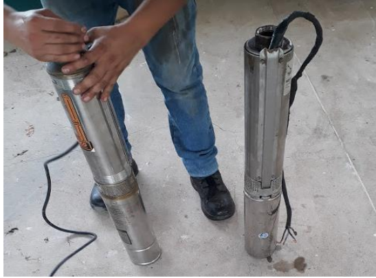
Figura 13-3: Sustitución de la bomba sumergible
