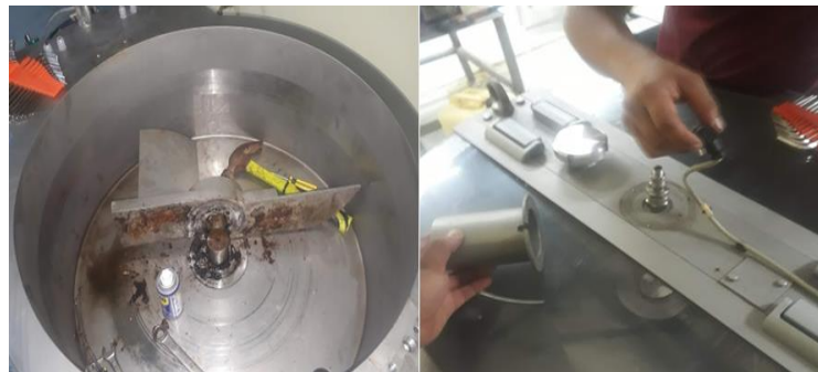
Figura 1-3: Desmontaje del atemperador
