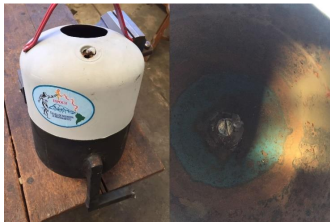
Figura 18-2: Depósito con corrosión
