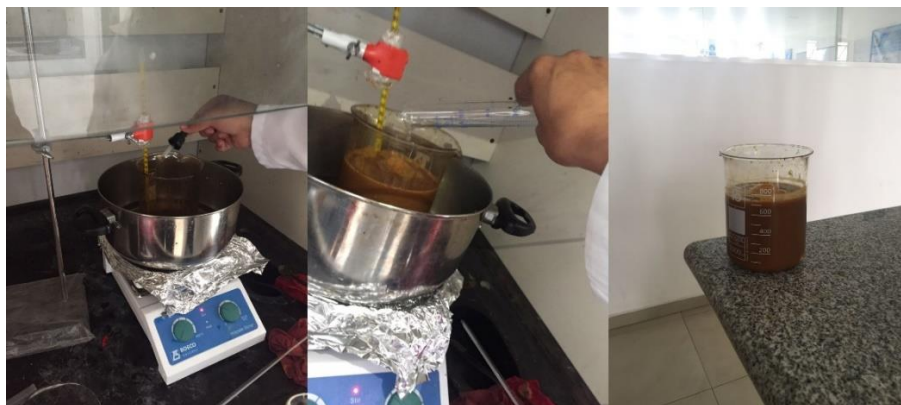
Figura 4-2: Proceso de agregación del agua destilada con el peróxido de hidrógeno
