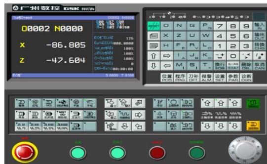
**Figura 1-2:** Tablero de control del torno Gsk 980 TDb.
