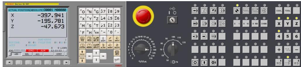
**Figura 2-2:** Tablero de control de la fresadora FANUC 0iMF.
