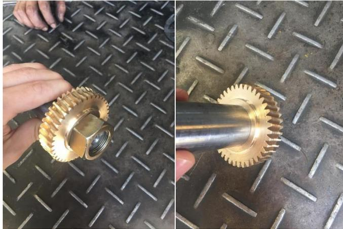
**Figura 68-3:** Corona helicoidal con garganta, hecha de bronce SAE 64
