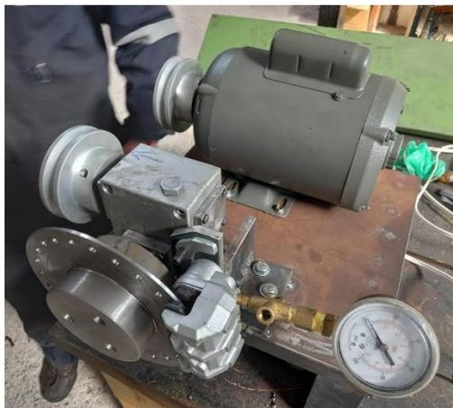
**Figura 80-3:** Motor, caja reductora y sistema de freno montados en la mesa del banco de pruebas
