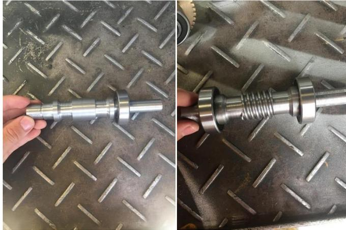
**Figura 65-3:** Tornillo sin fin de acero AISI 1045
