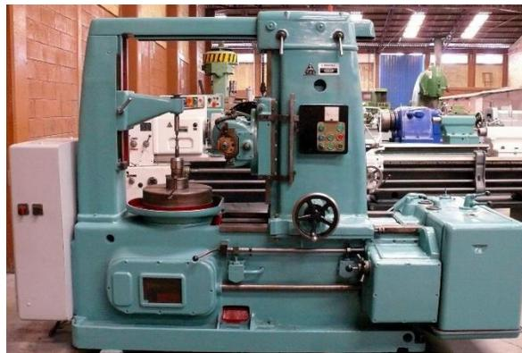
**Figura 3-2:** Generadora de engranajes.
