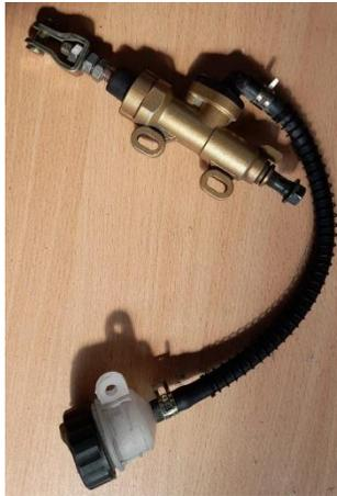
**Figura 75-3:** Sistema hidráulico para freno
