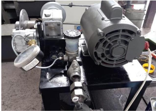
**Figura 81-3:** Montaje del tornillo regulador y del medidor de nivel de líquido de freno
