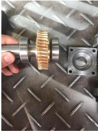
**Figura 69-3:** Montaje de la corona helicoidal en el eje de acero AISI 1018
