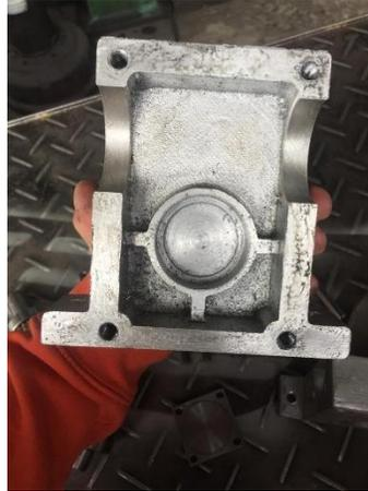
**Figura 63-3:** Carcasa rectificada de aluminio 1100
