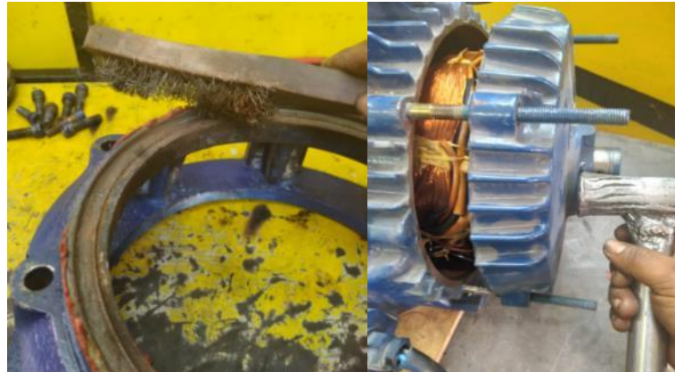
Figura 19-3: Limpieza y montaje del motor
