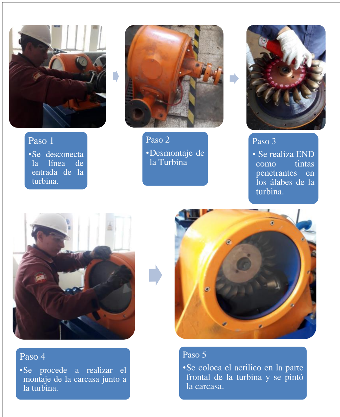
Figura 9-3: Procedimiento para la repotenciación de la turbina
