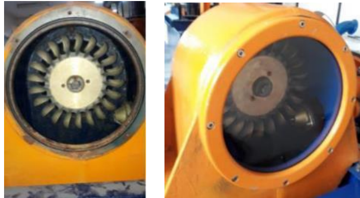
Figura 5-4: Comparación del estado de la turbina Pelton
