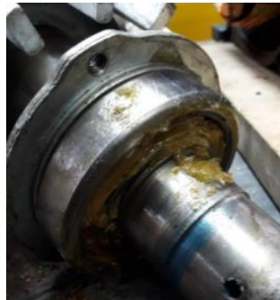
Figura 17-3: Proceso de engrasado de los rodamientos
