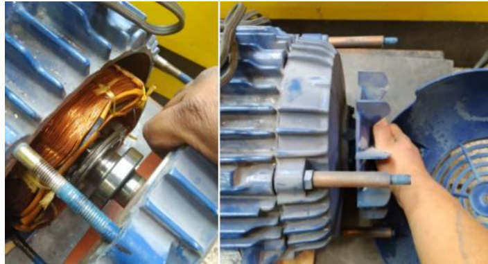
Figura 16-3: Inspección del rodamiento del motor
