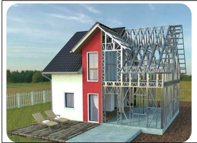
Figura 9-2: Construcción de vivienda con Steel Framing
