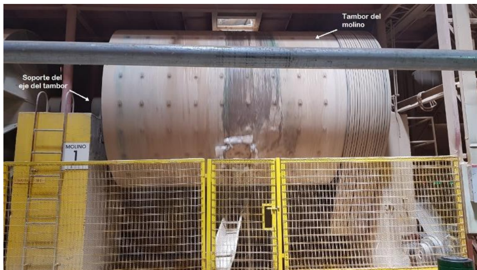
Figura 4-2. Molino de bolas
