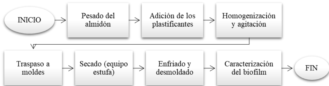
Gráfico 2-2: Diagrama de flujo de la obtención del plástico biodegradable. Realizado por: Caisapanta, Daily. 2021.
